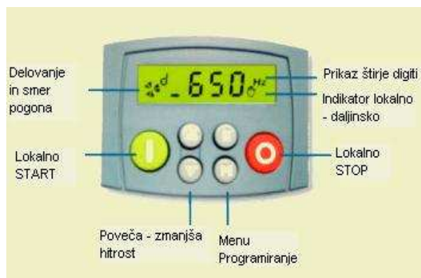
Slika 12: Posluževalni panel frekvenčnega pretvornika
