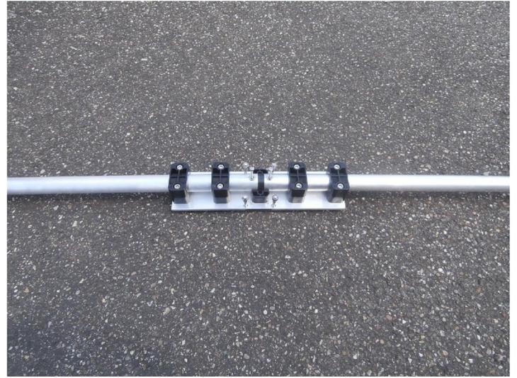
**Elementhalterung (hier Strahler) mit eingefügtem Mittelsegment (Ober- und Unteransicht)**
