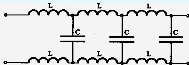
Ekvivalentna shema dvožilnega antenskega voda
