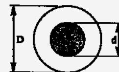
Asimetrični koaksialni kabel
