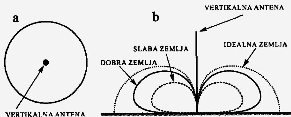
Sevalni diagram vertikalne (omnidirekcionalne) antene:
