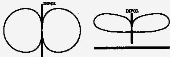
Vertikalni sevalni diagram vertikalnega dipola:
