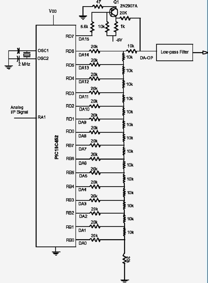
Primer implementacije FIR ali IIR filtra z PIC mikrokontrolerjem
