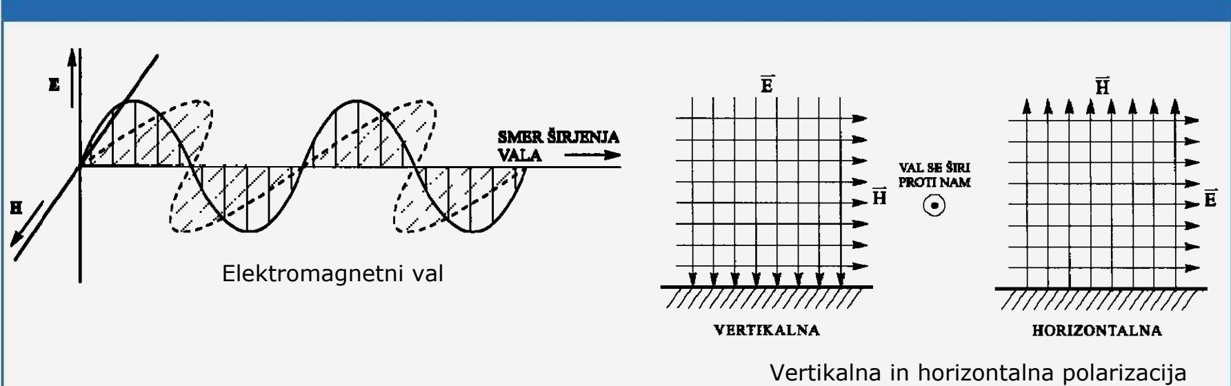
**Vertikalno polariziran elektromagnetni val:** električna komponenta polja je pravokotna na Zemljino površino.
