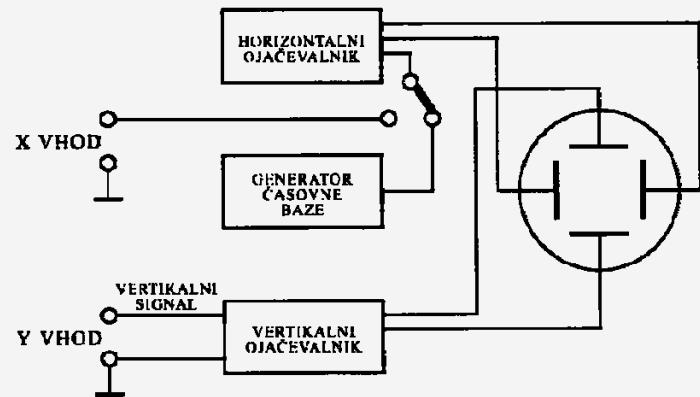
Osnovni princip delovanja osciloskopa
