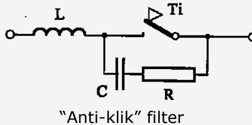
Neprestano vklapljanje in izklapljanje RF signala pri CW je enakovredno 100% AM modulaciji s pravokotnim modulacijskim signalom.
