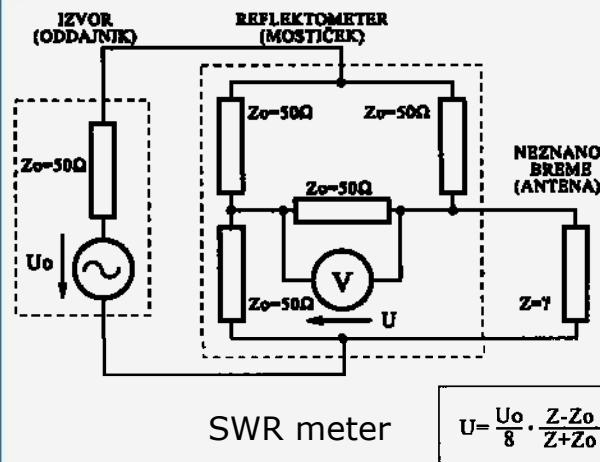
Odbojnost  $\Gamma$  predstavlja razmerje amplitud napredujočega in odbitega vala na visokofrekvenčnem vodu:
