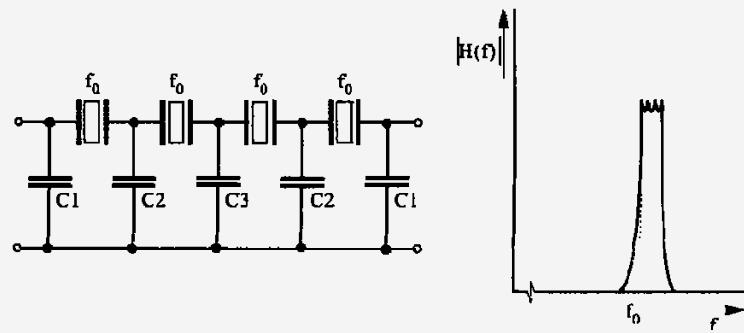
Pasovnoprepustni kristalni filter
