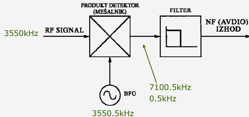
SSB signale demoduliramo s produkt detektorjem.
