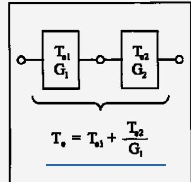
b) EKVIVALENTNA ŠUMNA TEMPERATURA SISTEMA ( $T_s$ ): je vsota ekvivalentne šumne temperature sprejemnika in temperature antene.
