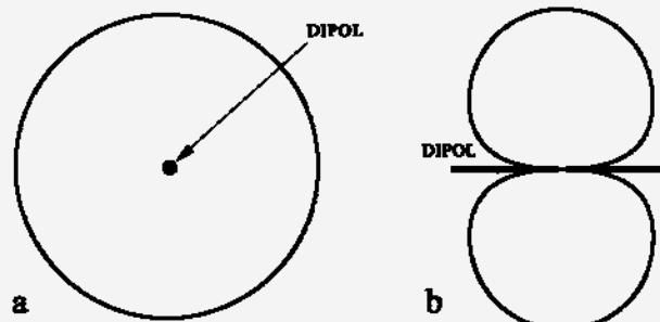
Sevalni diagram horizontalnega dipola v praznem prostoru:
