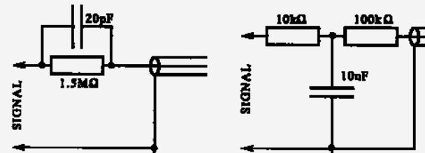
Sita na vhodu frekvenčnega merilnika
