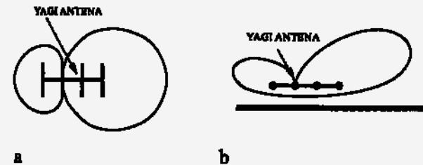
Sevalni diagram horizontalno polarizirane
