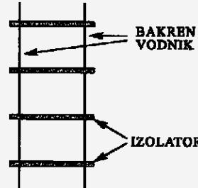
Dvožilni vod z zračnim izolatorjem
