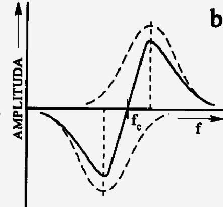
Balansni demodulator (a) in njegova frekvenčno-amplitudna karakteristika (b)
