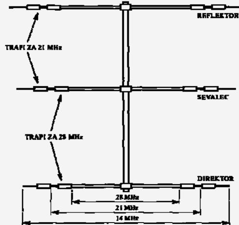
Yagi antena za delo na večih frekvenčnih pasovih
