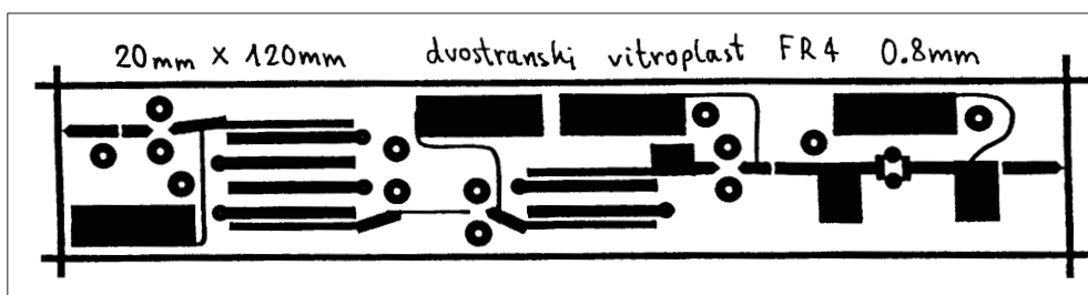
Tiskano vezje svetilnika za 2304 MHz
