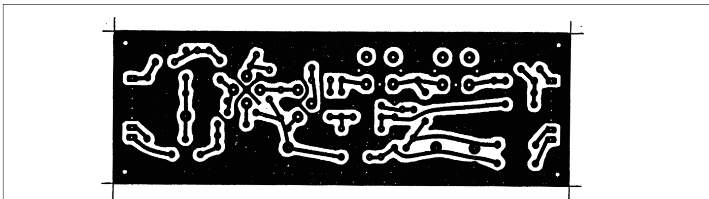
Slika 7. - Tiskanina nastavitve ojačenja in pasovne širine šumomerja.
