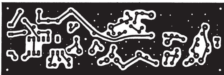
Slika 18 - Tiskanina medfrekvence sprejemnika (enostranski FR4, debeline 1.6 mm).
