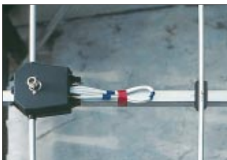
Bild 6: Montage von Erreger und Elementen an der Boomunterseite
