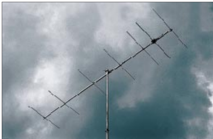
Bild 1: Ansicht einer fertig aufgebauten 7-Element-Kurzyagi, hier mit einer Eigenbau-Anschlußdose gemäß Bild 11
