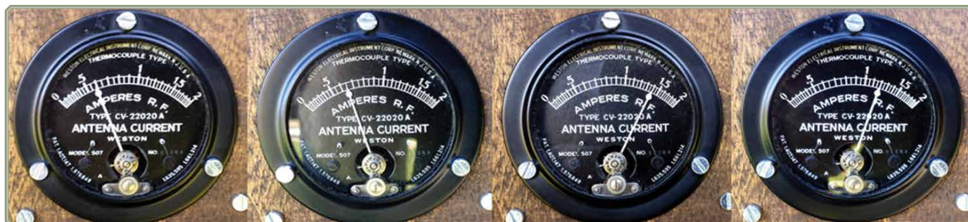
Slika 6: Antenska hišica; prvi levi-tok proti zemlji, neprilagojeno; drugi z leve-tok proti anteni, neprilagojeno; tretji z leve-tok proti anteni, prilagojeno in skrajno desno-tok proti zemlji, prilagojeno.
