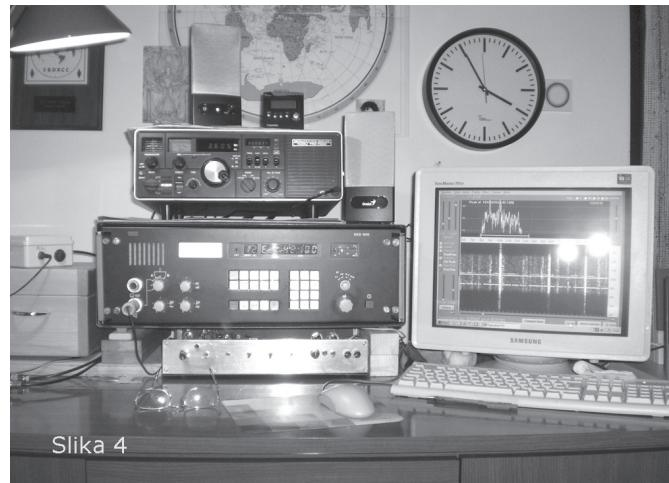
**Slika 4 - SWL shack S52AB, namenjen sprejemanju signala na VLF, LF, MF in HF področju z dvema starima gajbamama: RFI EKD 500 in pomožni FRG 7000. V spodnji škatli so NF filtri. Na ekranu se (sicer slabo), vidi aktualne signale, kontrole nivoja signalov in komande za upravljanje programa Spectrum V2.**
