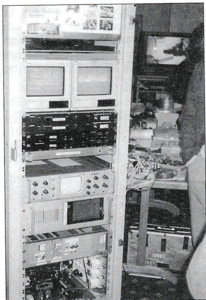
Slika 7 - Lokalni ATV repetitor.
