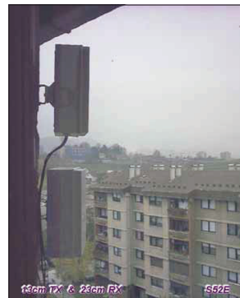
Slika 9 - TX, ojačevalnik in antena v eni škatlji
