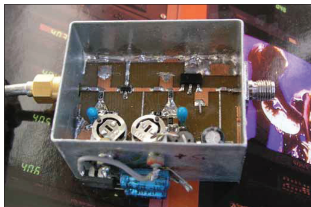
Slika 3 - Prvi prototip s klasičnimi trimmerji
