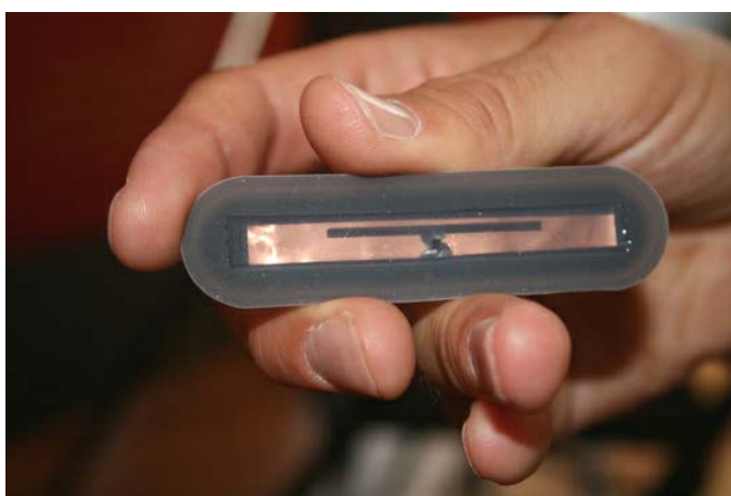
Pasivni odzivnik RECCO sistema 917 / 1834 MHz
