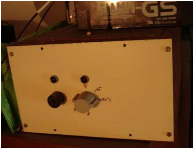
Slika 5: Doma izdelana peč za sušenje laka
