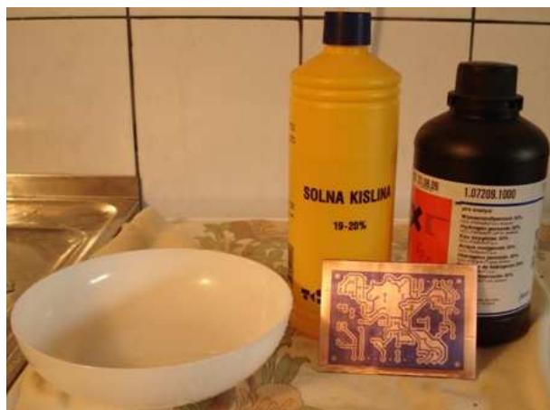
Slika 9: Priprava na jedkanje
