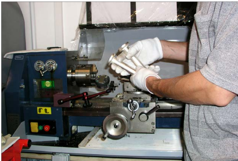
Slika 8 - Optična kontrola oddajnih tuljav - resonatorjev po stružnju
