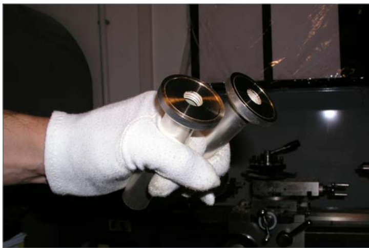
Slika 9 - Oddajna resonatorja po struženju
