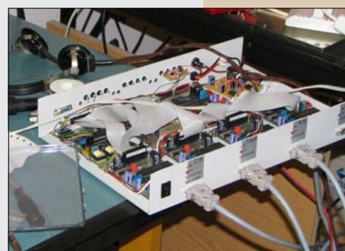
Slika 6 - S54S repetitorski krmilnik
