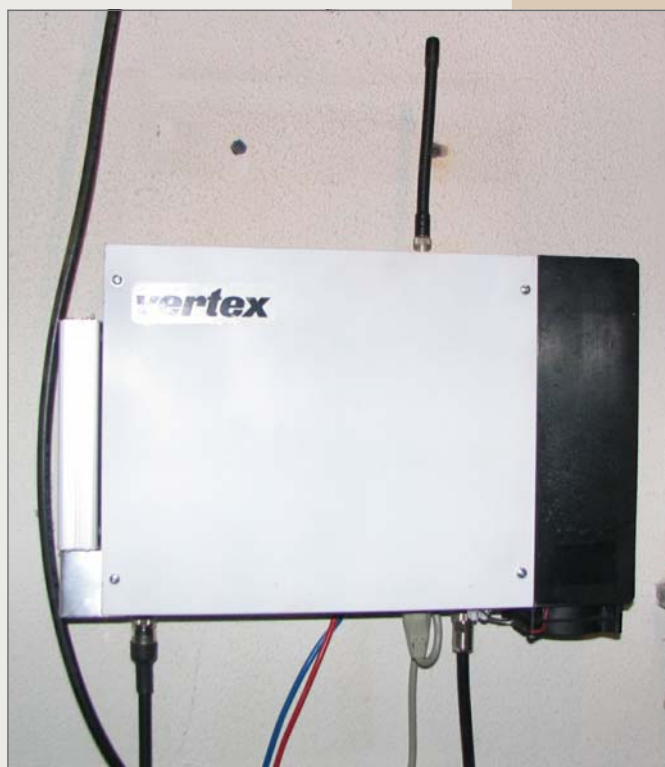
Slika 3 - Novi S55UMX repetitor na svojem mestu
