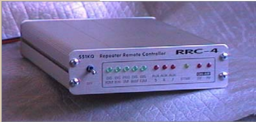
Slika 2 - 1997 dvoprocorski RRC-4 krmilnik DTMF krmiljenje, Voice ID, Sysop dostop
