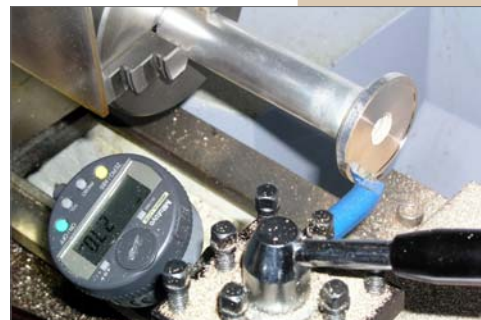
Slika 10 - Pobiranje materiala v notranjosti za okoli 0.20 mm - izdelava sedišča
