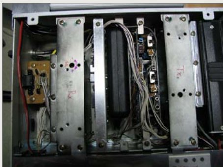
Slika 1 - Pogled v odprti Vertex repetitor od zgoraj
