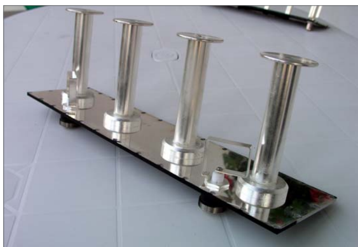
Slika 3 - Odprt oddajni pasovno propustni filter RS4643H
