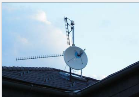
Slika 5 - Parabola z integriranim 3cm oddajnikom
