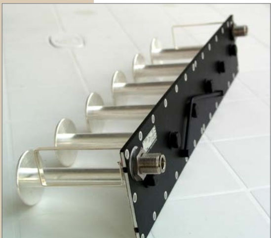
Slika 4 - Notranjost sprejemnega filtra RS4411P
