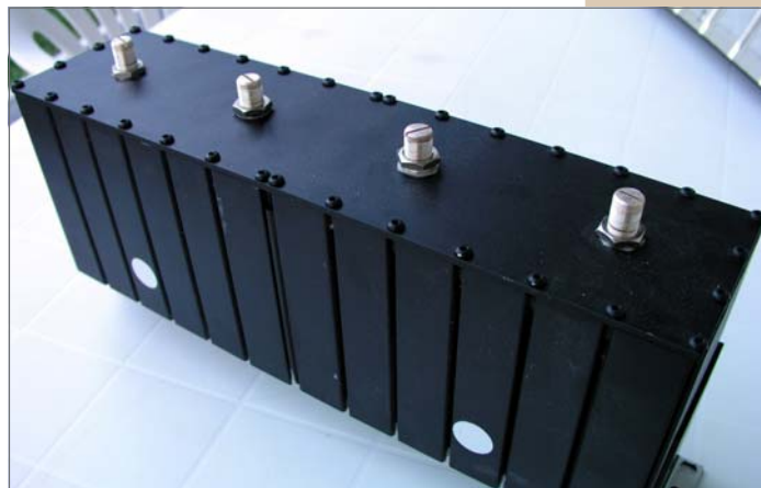
Slika 1 - Oddajni pasovno propustni filter Radiosystem RS4643H
