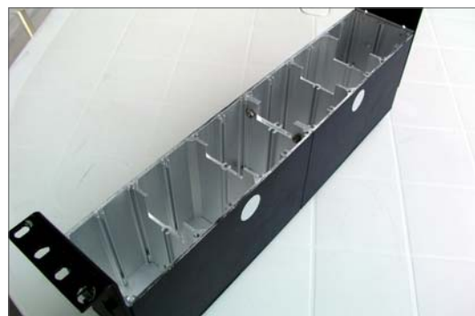
Slika 6 - Notranjost loncev sprejemnega filtra
