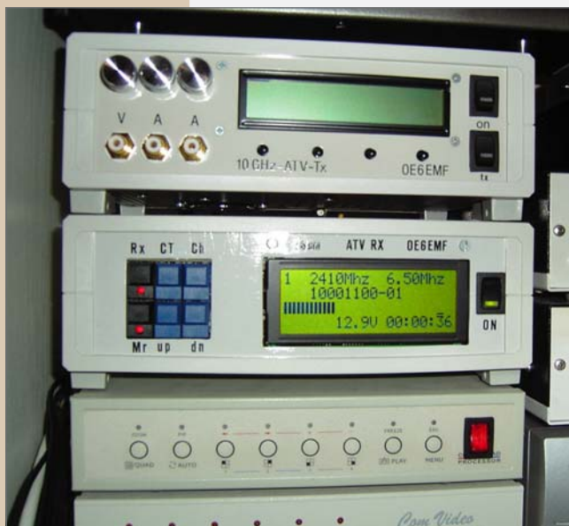
Slika 3 - 10GHz in 2.4GHz oddajnik ter dva video Quad-a spodaj
