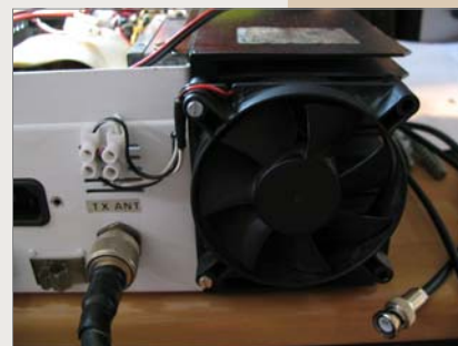
Slika 2 - Hlajenje končne stopnje
