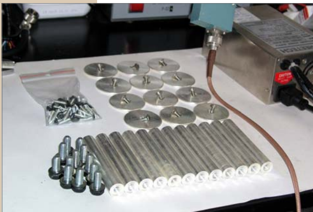
Slika 5 - Sestavni deli dveh sprejemnih filtrov pripravljeni za obdelavo na stružnici
