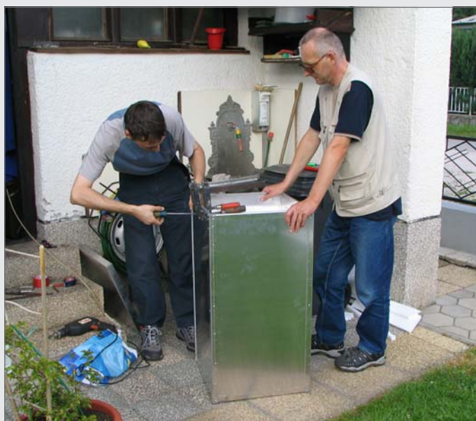
Slika 4 - Priprava ohišja za VHF duplexer (S56WAN, S52CX)
