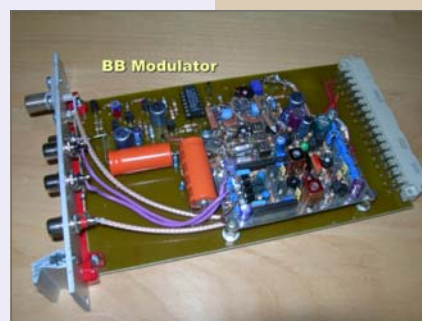
Sliki zgoraj 7 in 8 - Šest kanalno AV vozlišče in BB modulator Slike levo 9, 10 in 11 - DTMF sendvič, ter Video S-meter (spodnji dve)
