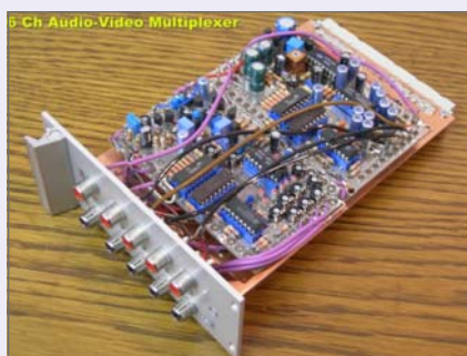
Sliki zgoraj 7 in 8 - Šest kanalno AV vozlišče in BB modulator Slike levo 9, 10 in 11 - DTMF sendvič, ter Video S-meter (spodnji dve)
