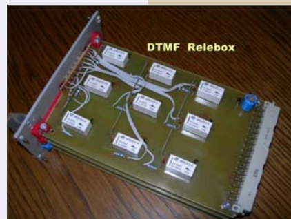
Sliki 5 in 6 - DTMF dekoder in njegov relejni preklopnik
