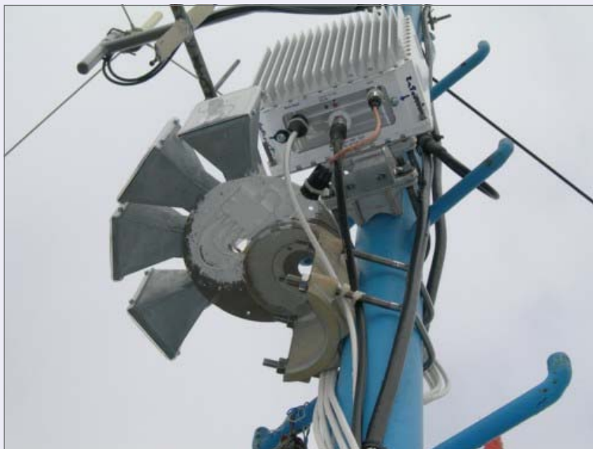
Slika 20 - Končni izgled 10GHz oddajnega dela ATV repetitorja z antenami
