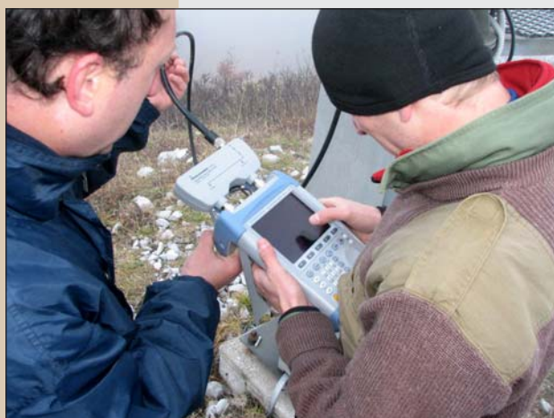
Slika 6 in 7 - Montaža novega repetitorja (slika 6), preverjanje prilagojenosti antene (slika 7)
