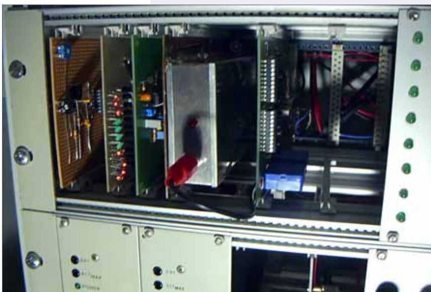
Slika / Bild 7 - Detailaufnahme oben: Feldstärke- und Hubmessung, CPU-Karte, 2 Karten Synchronimpulserkennung, A/V Umschalterkarte
