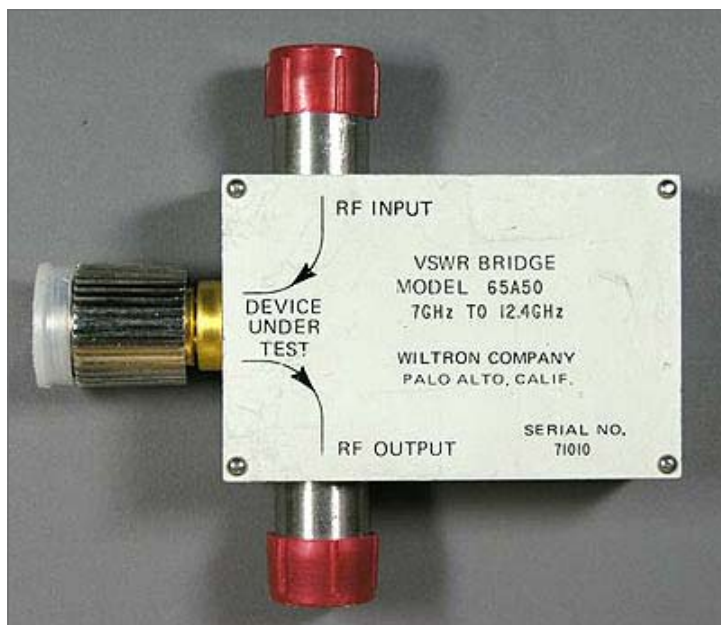
SWR bridge - merilni most za frekvence med 7 in 12,4 GHz
