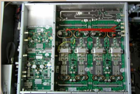
DVB oddajnik, procesorski del (zgoraj) ter končni ojačevalnik
