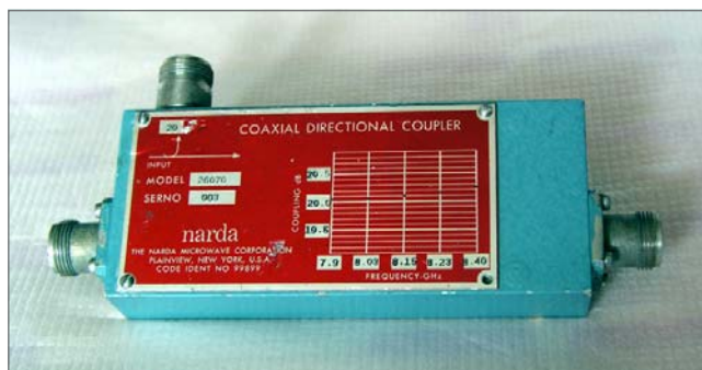
20dB smerni sklopnik za frekvence med 7.9 in 8.4 GHz
