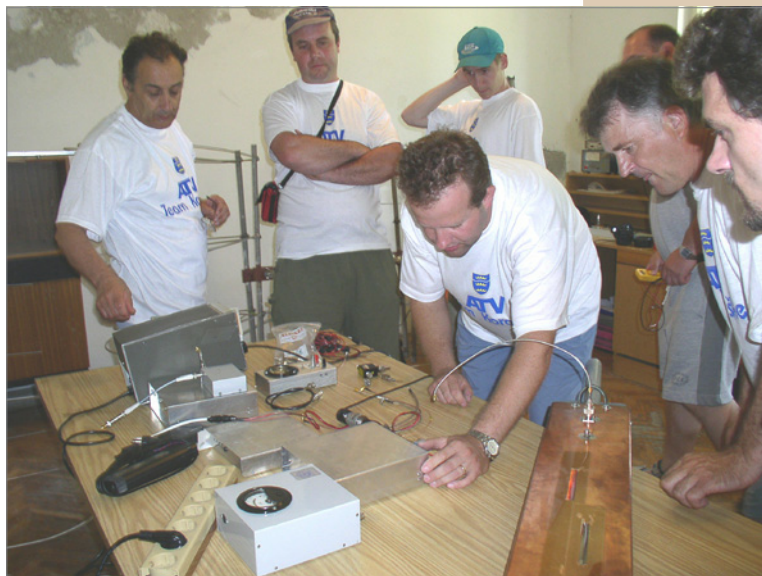
ATVS fielday Strojna 2003 - meritve prilagojenosti 23cm in 13cm anten
