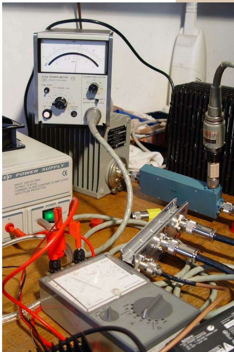
Preverjanje delovanja združilnika obeh ATV oddajnikov
