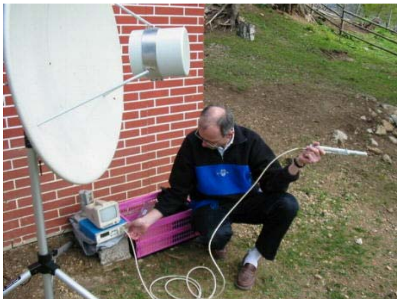
Signala iz S55TVA repetitorja je bilo dovolj za normalen sprejem z mini Jagi anteno
