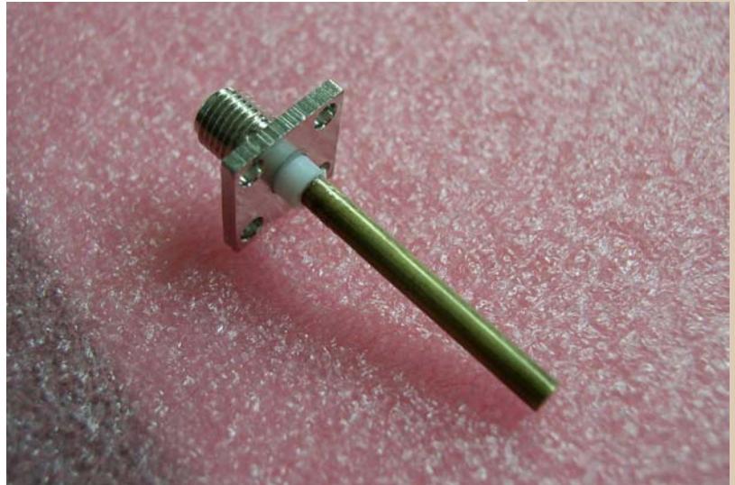
Četrvalni žarilec je pripravljen za montažo v valovod
