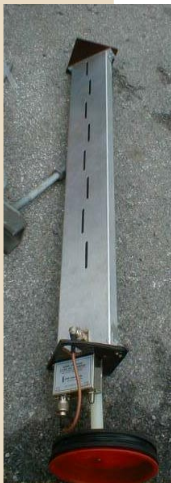
Tuja antena brez prilagoditvenega vijaka, tik pred montažo v Radom
