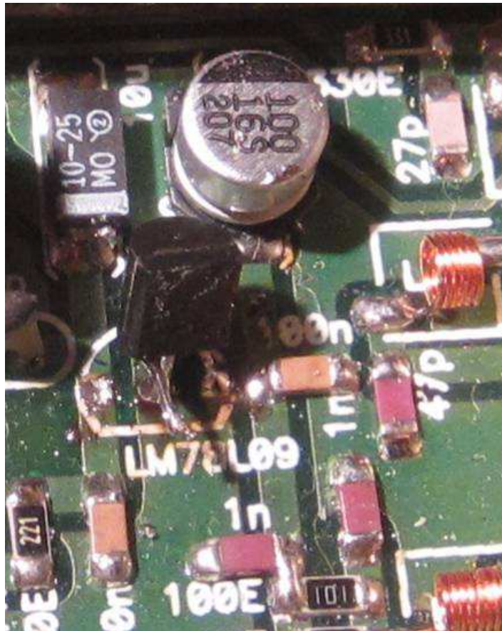
Slika 21 - 78L09 prilotamo nazaj – samo vhod in GND priključek
