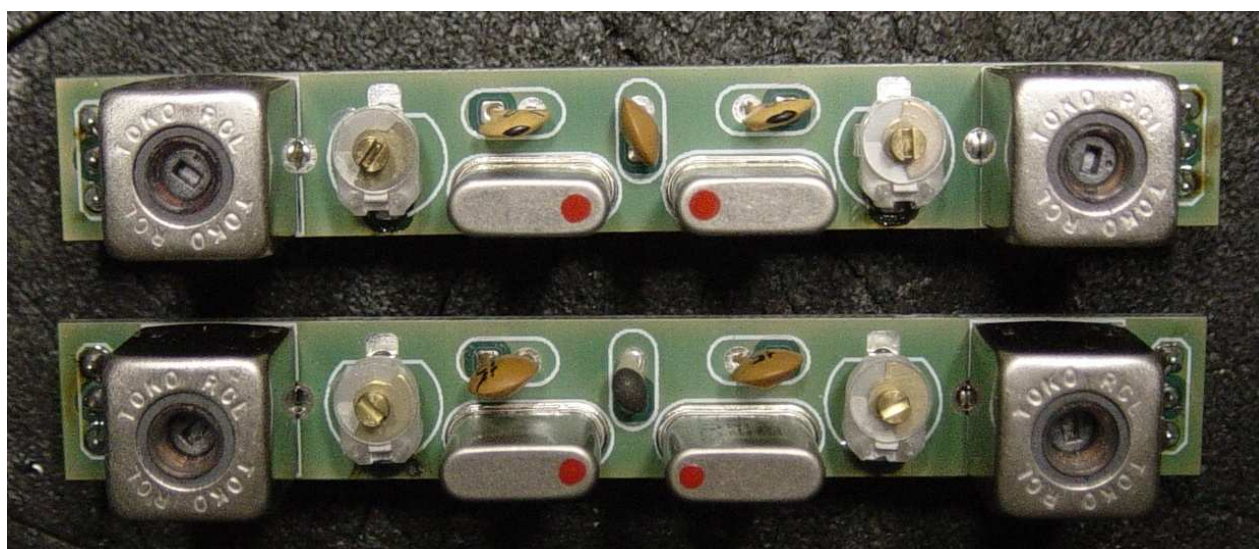
Slika 6 – natični filter – pozor na orientacijo ohišij kristalnih filtrov
