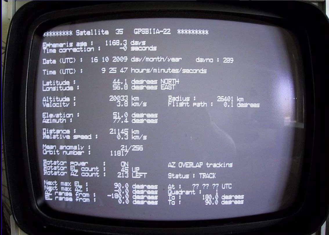
1988: izračun tirnice satelita in vodenje anten
