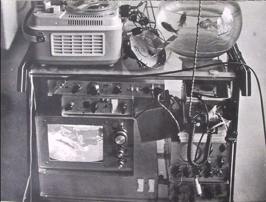
1979: sprejemnik za satelit Meteosat-1 na 1.7GHz
